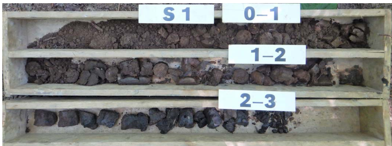
Obr. 2: Geologický profil zastižený sondou S1.
