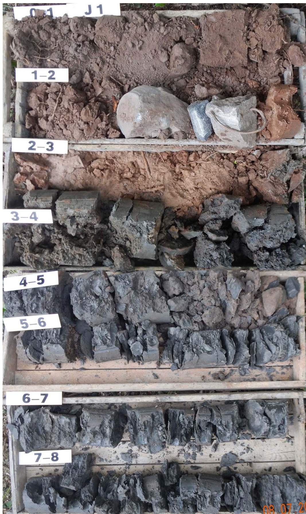
Obr. 1: Geologický profil zastižený vrtem J1.
