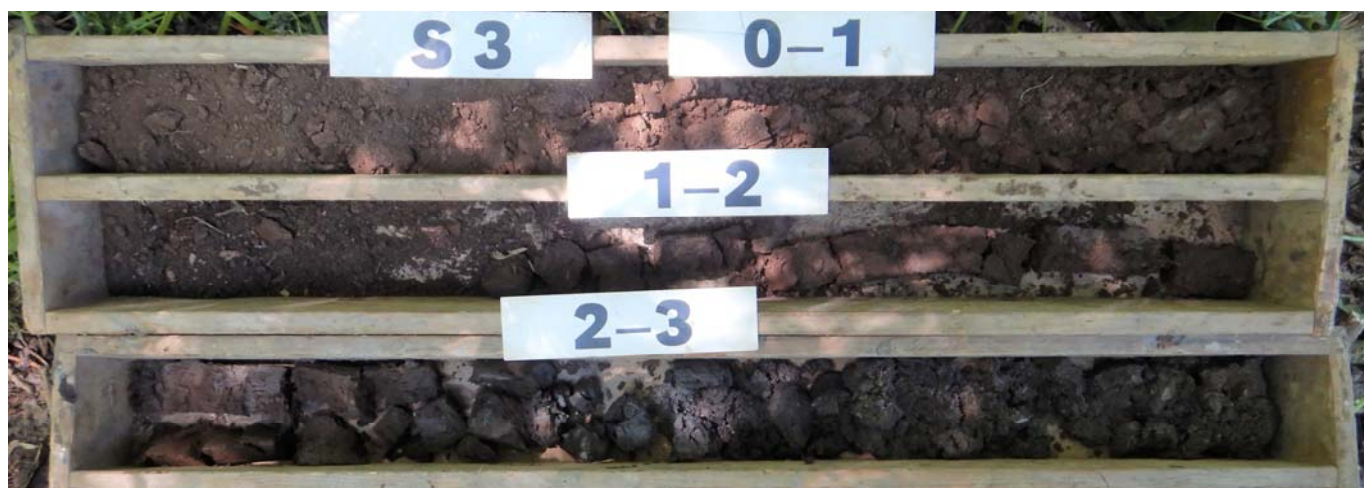
Obr. 4: Geologický profil zastižený sondou S3.
