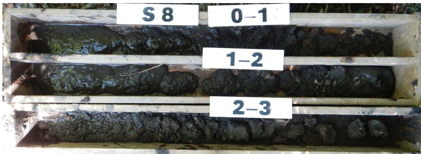
Obr. 9: Geologický profil zastižený sondou S8.
